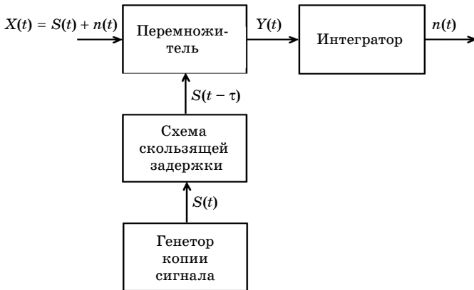
Рис. В.2. Обобщенная схема оптимального корреляционного приемника
