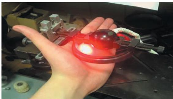
Рис. 2 Измерение коэффициента диффузного отражения с помощью интегрального фотометра
