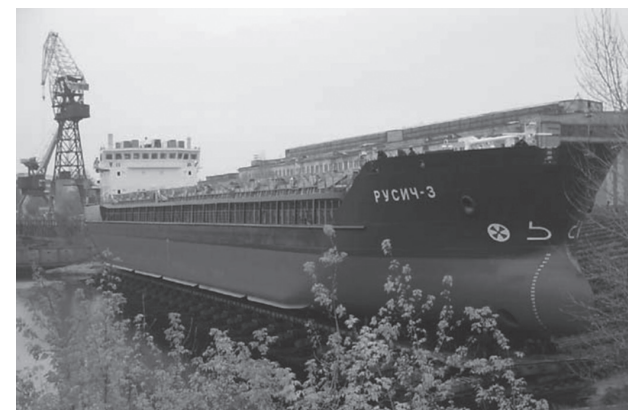
Рис. 1.9. Спуск судна на слипе грузоподъемностью 6000 т
