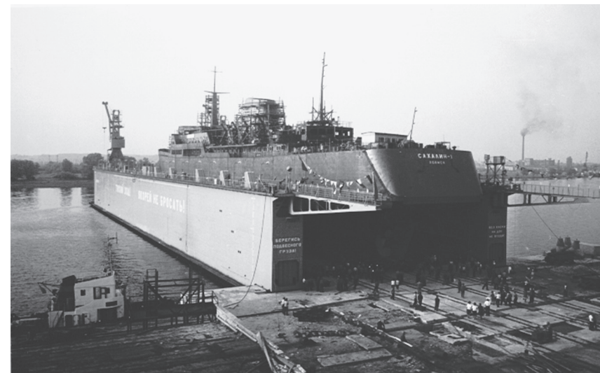
Рис. 1.12. Накатка судна с берегового стапеля на передаточный плавучий док
