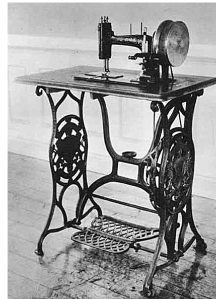
Рис. 10.4. Доводочный станок Иогансона на основе швейной машинки
